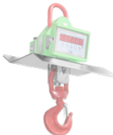
Hitzeschild zum Schutz vor hohen Temperaturen (max. 80°C). Der Hitzeschild verhindert, dass das Gewicht des Krans durch die Hitze unter dem Schild in Form von Infrarotstrahlen schnell ansteigt. Dank des Hitzeschildes ist es möglich, Wärmequellen mit starker Infrarotstrahlung schnell zu überfahren. Die Zeit, die der Kran über diesen Quellen bleiben kann, hängt von der Art der Energiequelle und dem Abstand der Kranwaage zu ihr ab.
